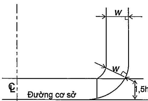
Hình 3.5 Chiều rộng yêu cầu của mạn kép
