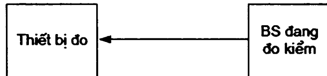
Hình D.1 - Sơ đồ đo phát xạ ngoài băng
