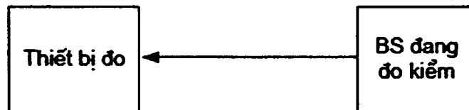
Hình D.2 - Sơ đồ đo tần số RF, công suất mã và điều chế phát
